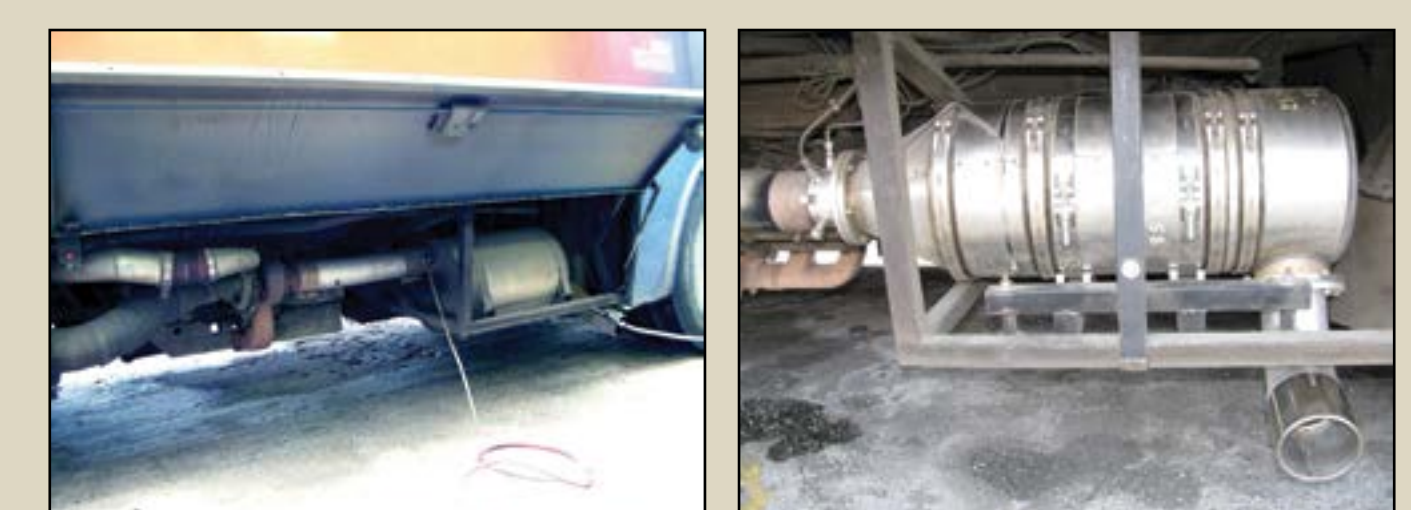
Ikarus 280.40 típusú, BPO-429 forgalmi rendszámú autóbusz kipufogódobbal és HJS 94622034 típusú részecskeszűrővel
